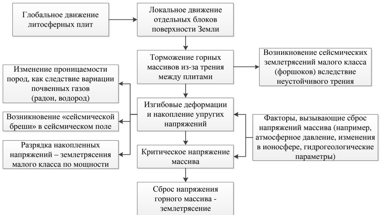
Рисунок 3 — Схема процессов подготовки и землетрясения и сброса упругой энергии [по Уткин, Юрков, 2009а].
