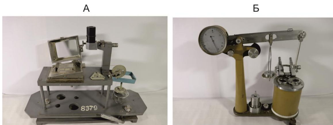
Рис. 3.3. Внешний вид вискозиметра ПДС-10 (А) и реовискозиметра Гёплера (Б).
