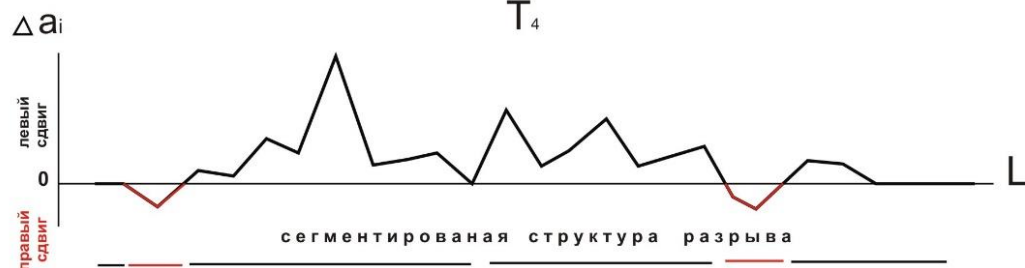
Рис. 4.9. Вариации приращения амплитуды смещения \Delta a_i по простиранию разрыва L в формирующейся сдвиговой зоне, зафиксированные во временной последовательности T_1, T_2, T_3, T_4 с дискретностью 1 минута.
