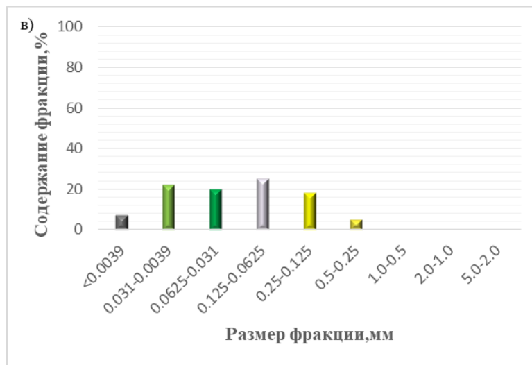
Рис. 24. Гистограмма распределения содержания зерен минералов различных фракций в алевролитах, аргиллитах и песчаниках фации нижнего склона фронта дельты. Среднеботуобинское месторождение: а) скв. № 2178, обр. 18896/16, глубина по бурению 2208,31 м (глубина по ГИС 2208,31 м); б) скв. № 2178, обр. 9579/18, глубина по бурению 2669,7 м (глубина по ГИС 2670,28 м); в) скв. № 9301, обр. 6267/18, глубина по бурению 1933,47 м (глубина по ГИС 1933,84 м).
