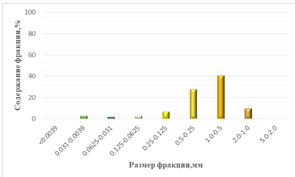
Рис. 47. Гистограмма распределения зерен различных фракций в песчаниках фации ФК. Среднеботуобинское месторождение, скв. № 2236, обр. 6846/18, глубина по бурению 2725,16 м (глубина по ГИС 2728,76 м).
