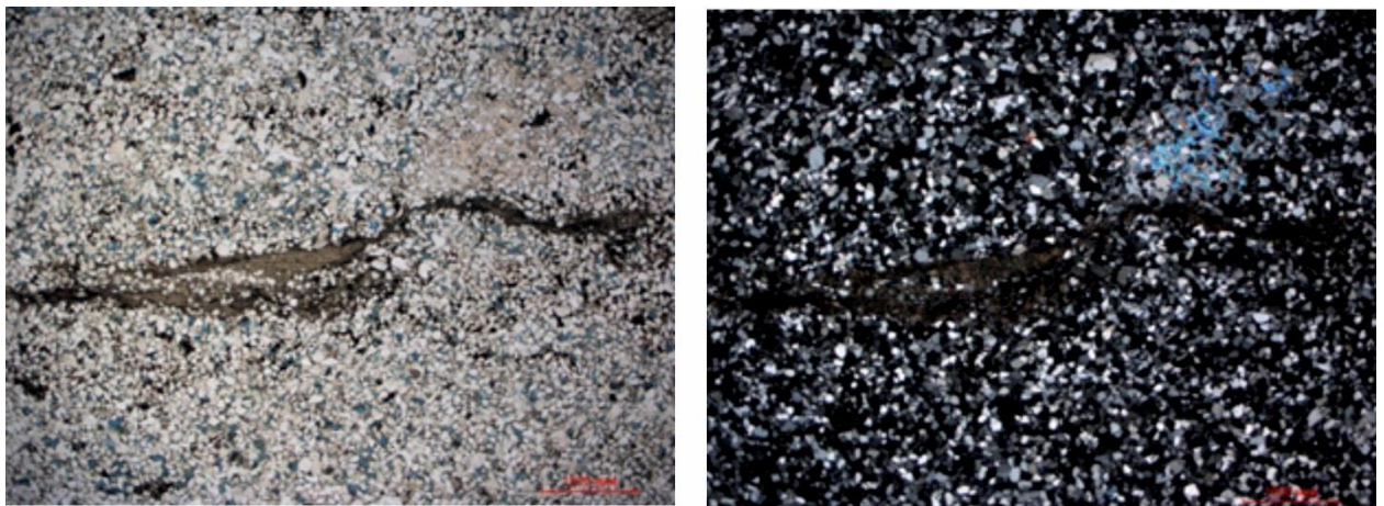
Рис. 34. Песчаники мелко-тонкозернистые, алевритистые, аркозовые, с глинистым порово-пленочным и сульфатным поровым цементом (фото шлифа слева, вид – без анализатора, увеличение 20х; фото шлифа справа, вид – с анализатором, увеличение 20х). Среднеботуобинское месторождение, скв. № 9301, обр. 6275/18, глубина по бурению 1936,67 м (глубина по ГИС 1937,04 м).
