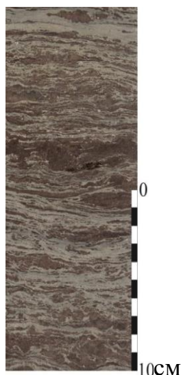
Рис. 54. Волнисто- и линзовиднослоистые песчаники фации лагунной фации с приливно-отливным влиянием. Фото вертикального среза керна в дневном свете.
