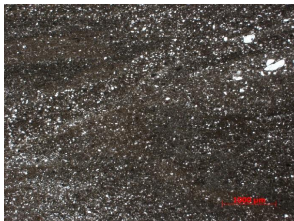
Рис. 32. Алевролиты крупно-мелкозернистые песчанистые, с глинистым цементом (фото шлифа, вид – без анализатора, увеличение 25х). Среднеботуобинское месторождение, скв. 2178, обр. 18908, глубина по бурению 2210,13 м (глубина по ГИС 2208,33 м).
