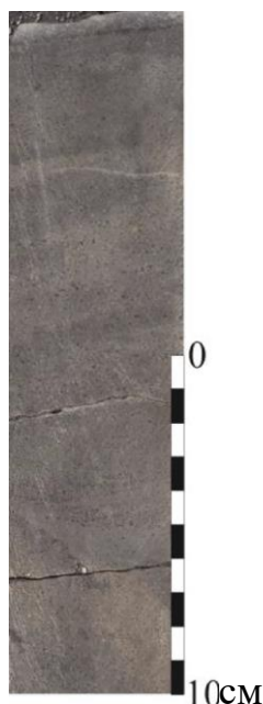
Рис. 50. Разнозернистые песчаники прибрежной фациальной зоны (трансгрессивный пласт с неясно выраженной слоистой текстурой). Фото вертикального среза керна в дневном свете.
