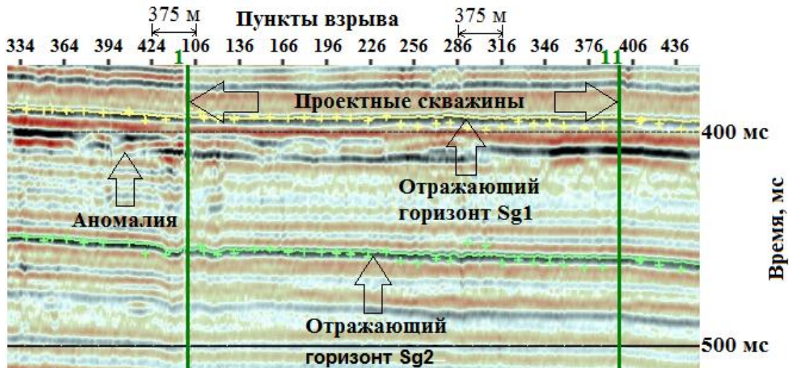
Рисунок 4.8 – Фрагмент сейсмического мигрированного временного разреза, показывающий аномалию, связанную с газонасыщением. Обозначения: Разноцветные «плюсики» – поперечные сейсмические разрезы с увязанными отражающими горизонтами.
