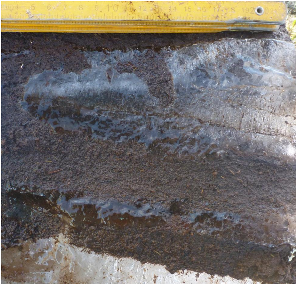
Рис. 42. Шлиры в торфе инфильтрационно-сегрегационного льда в полигональных торфяниках южной тундры (фото Тихонравовой Я.В.)
