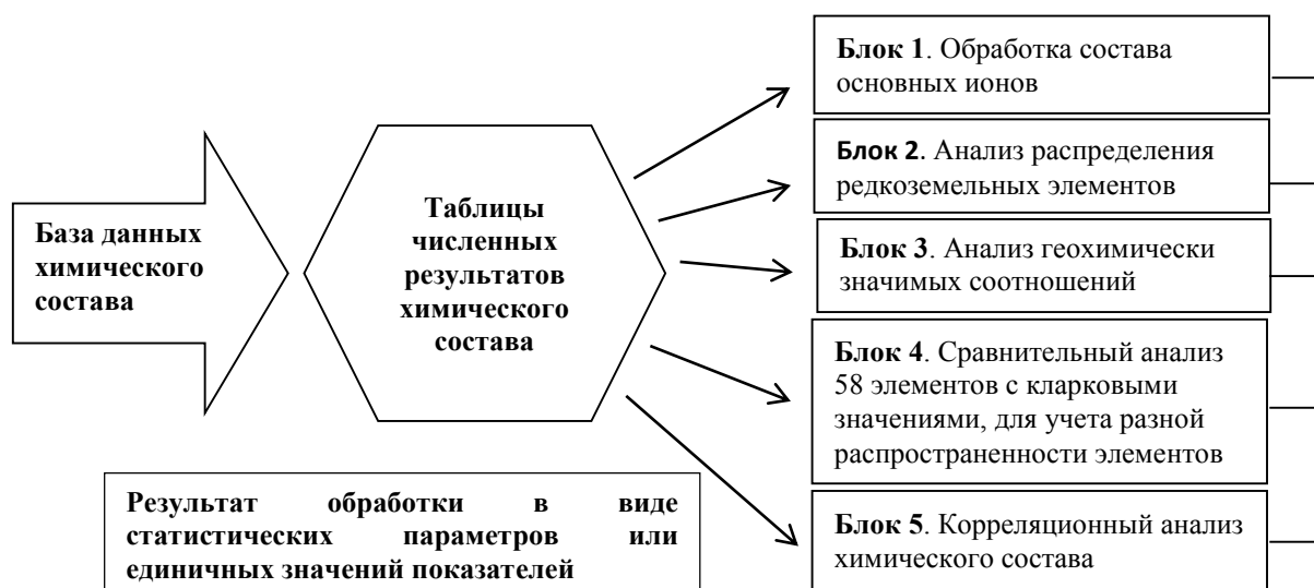
Рис. 6. Блок-схема программы анализа результатов исследований ионного и микроэлементного состава льдов, вод и отложений
