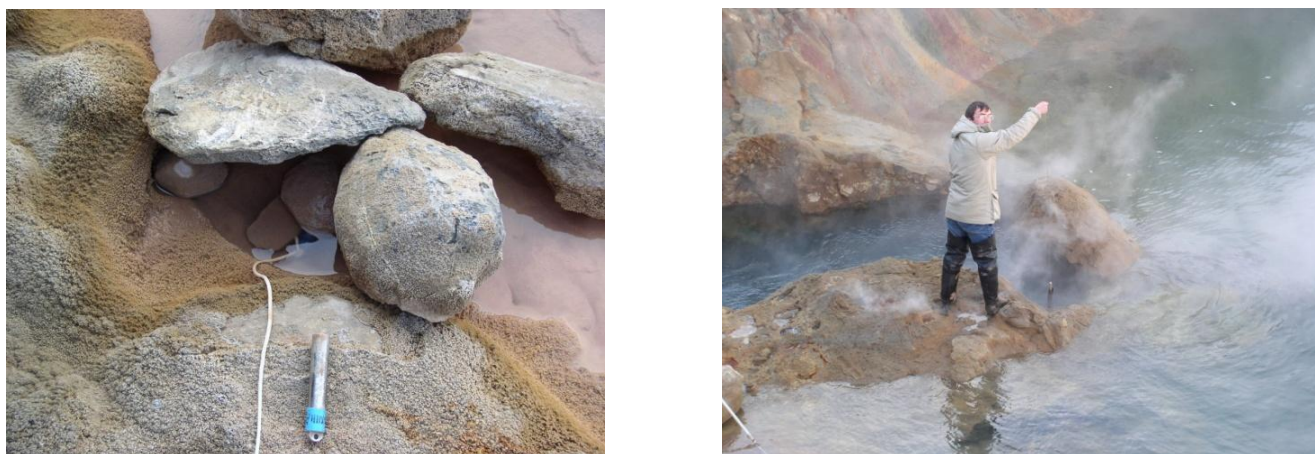
Рис. 2.3. Установка температурного логгера НОВО U12-015 в ванну гейзера Большой для мониторинга режима его извержений.
