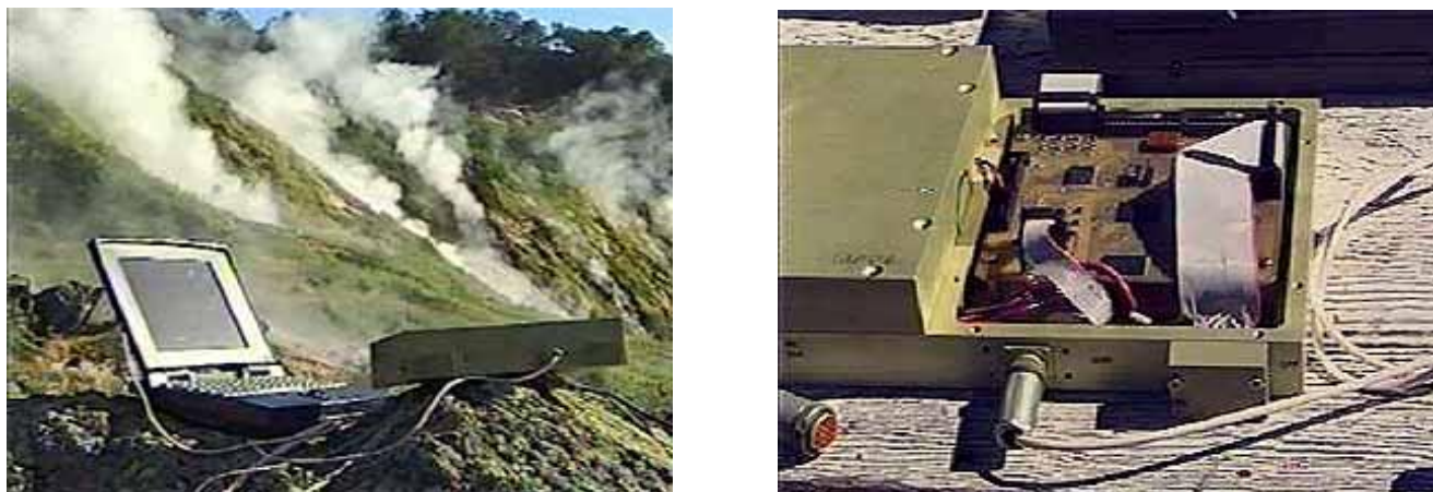
Рис. 2.2. Комплект аппаратуры, регистрирующей периодичность извержений гейзеров методом замыкания цепи [Дрознин, 2007].
