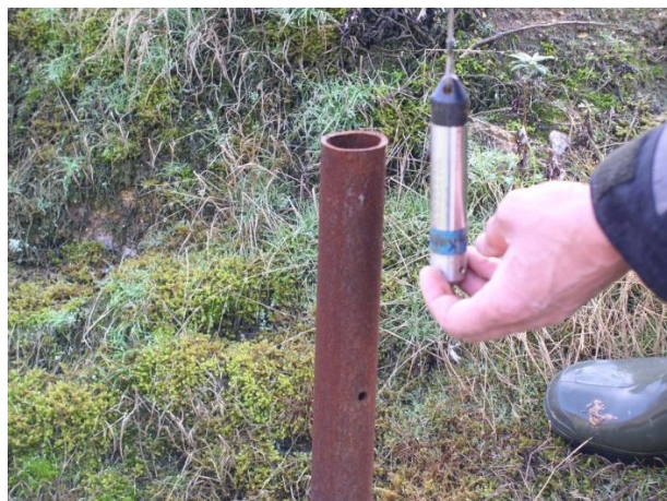
Рис. 2.5. Установка двух логгеров давления U20-001-04 для контроля уровня Подпрудного озера-1: один - в озере, другой - на берегу.
