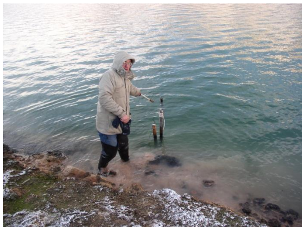
Рис. 2.5. Установка двух логгеров давления U20-001-04 для контроля уровня Подпрудного озера-1: один - в озере, другой - на берегу.
