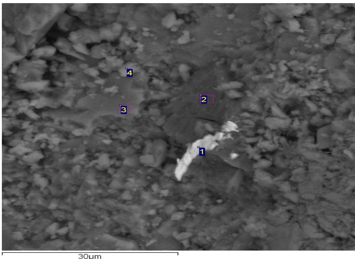
Рис. 5.14. Электронно-микроскопический снимок новообразований на поверхности известняка
