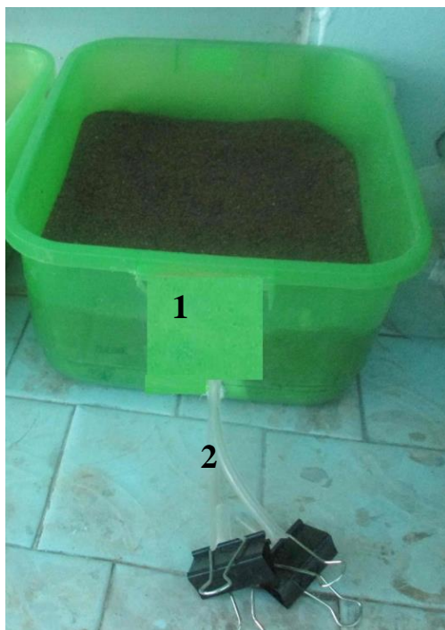
Рис.2.1 Установка, предназначенная для проведения экспериментов по исследованию взаимодействия кислых вод с известняком: 1 - контейнер размером 420x320x165. 2 – сливной кран
