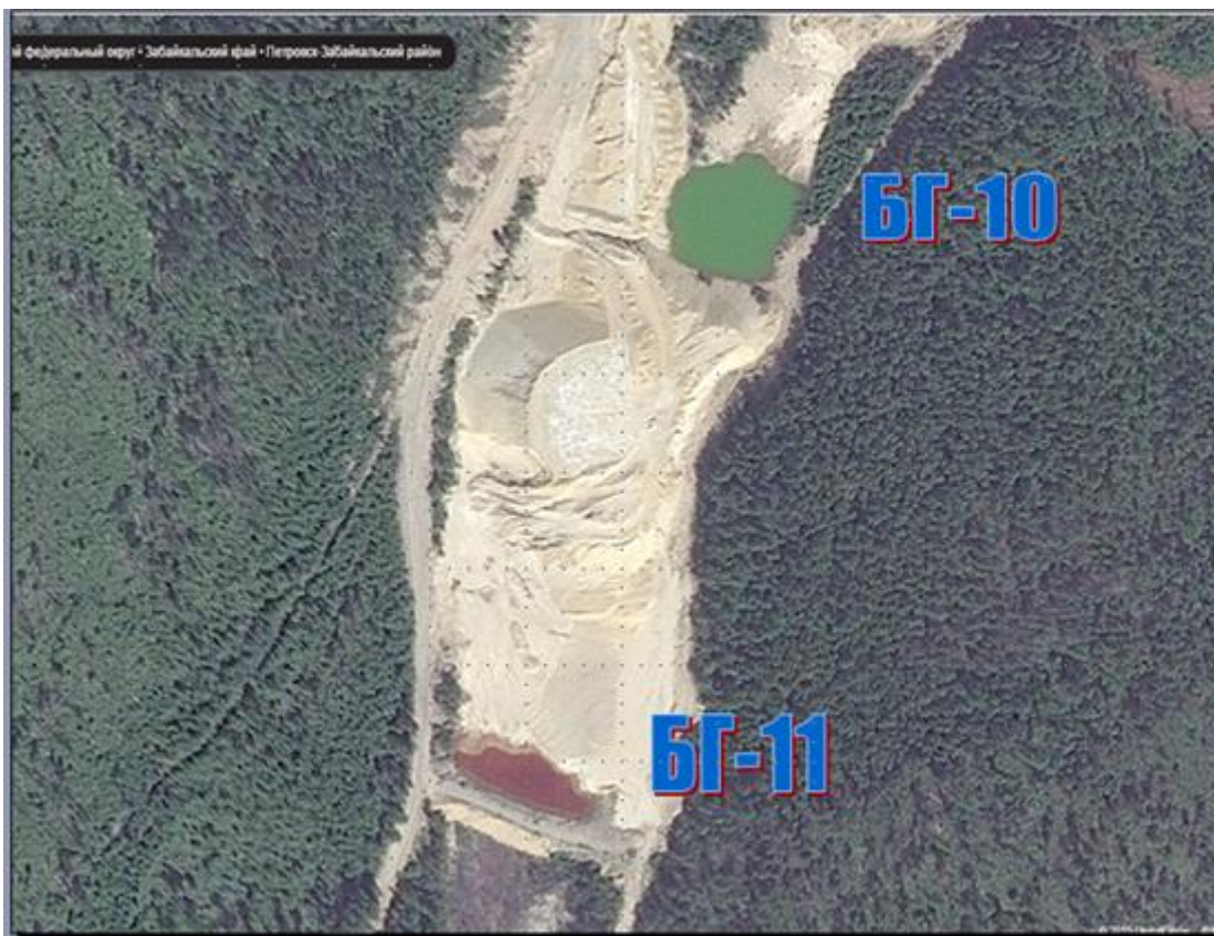
Рис.3.13. Космоснимок отстойников в долине р. Зун-Тигня с местами отбора проб воды. Ширина долины, измеренная по нижней дамбе составляет 50 м
