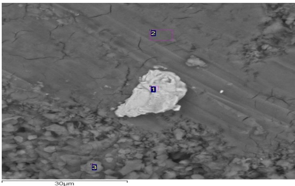
Рис.5.13. Гидроокислы железа на поверхности кальцита
