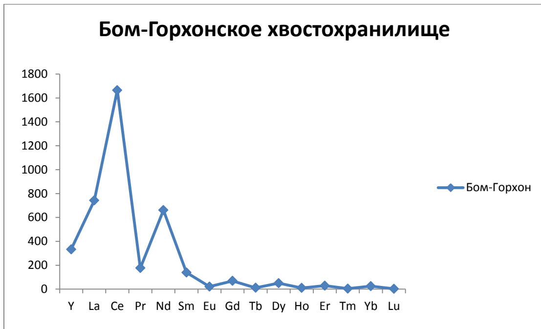
Рис. 4.2. Содержание иттрия и лантаноидов в поровых водах хвостохранилищ Джидинского и Бом-Горхонского ГОКов, мкг/дм 3
