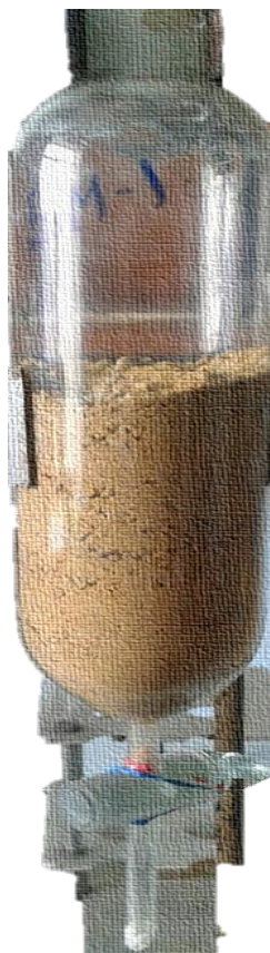
Рис.2.4. Колонка высотой 18 см, диаметром 6 см, где песок, m=500\text{г} .
