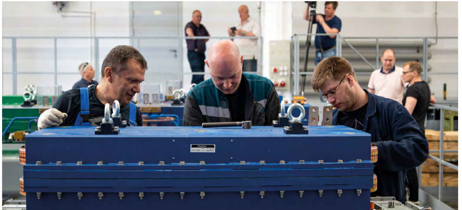
Сборка фрагментов синхротрона-бустера
